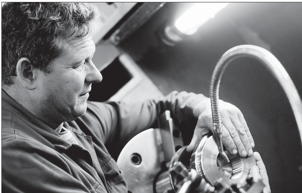
Tamme de Groot plaatst een zuiger op een cilinderstuk.
