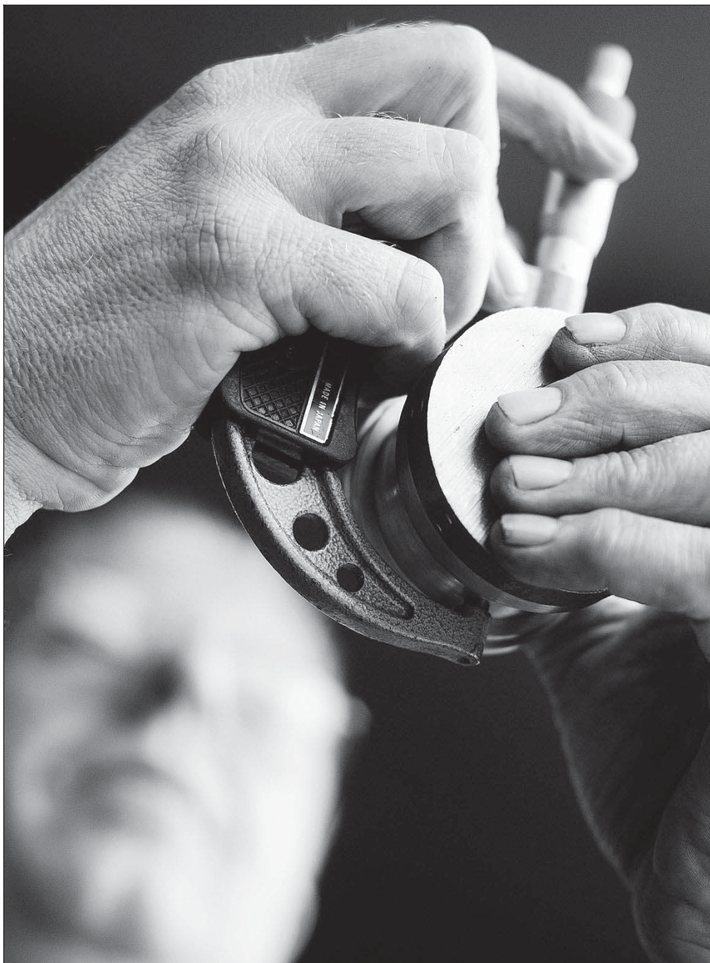
Jappie Talsma meet de diameter van een zuiger bij KBM in Sint Anne.
